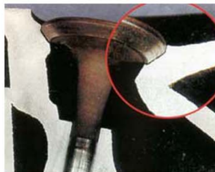
Uitlaatklep zonder Flashlube klepsmering
