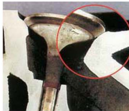
Uitlaatklep met Flashlube klepsmering
